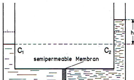
Abbildung 131 Transport der Flüssigkeit durch die Membran dauert so lang bis der Schweredruck auf der rechten Seite ein weiteres Eindringen verhindert.
