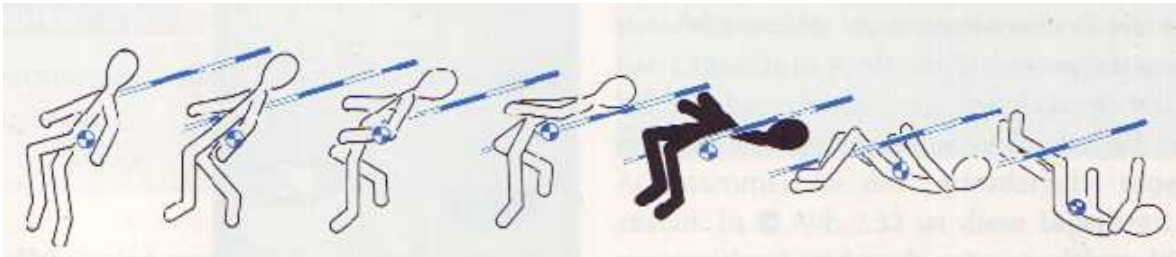
Abbildung 61: Ein Hochspringer verlegt seinen Schwerpunkt nach unten, damit er weniger Hubarbeit leistet (nach Harten).
