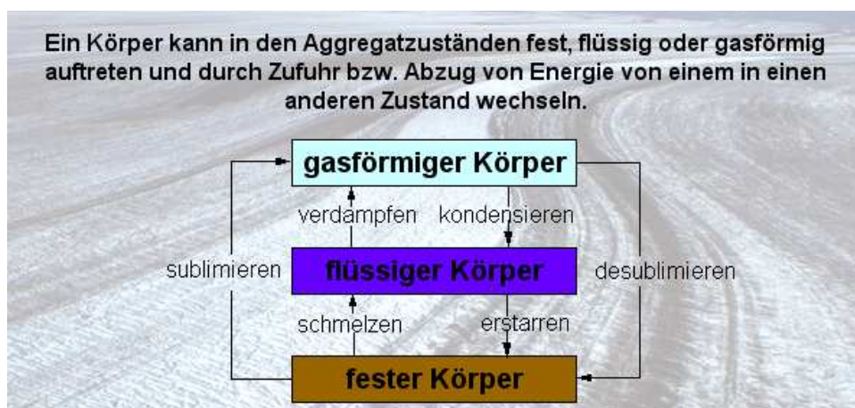
Abbildung 122: Der Übergang eines Körpers in einen Aggregatzustand ist mit einer Energieumwandlung verbunden.
