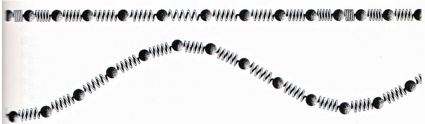
Abbildung 152: Momentaufnahme einer longitudinalen und transversalen Welle
