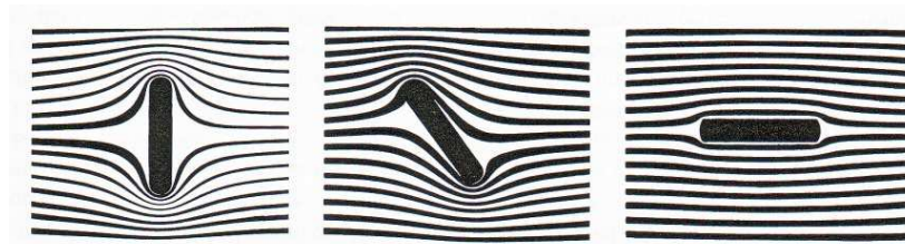
Abbildung 97: Die Stromlinien einer laminaren Strömung um ein Hindernis (nach Pohl)
