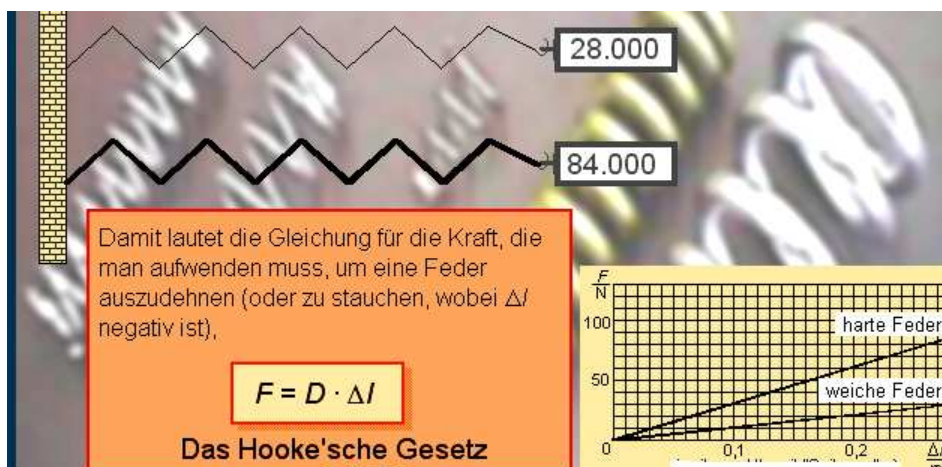
Abbildung 39: Proportionalität zwischen Kraft \vec{F} und Längenänderung \Delta\ell .
